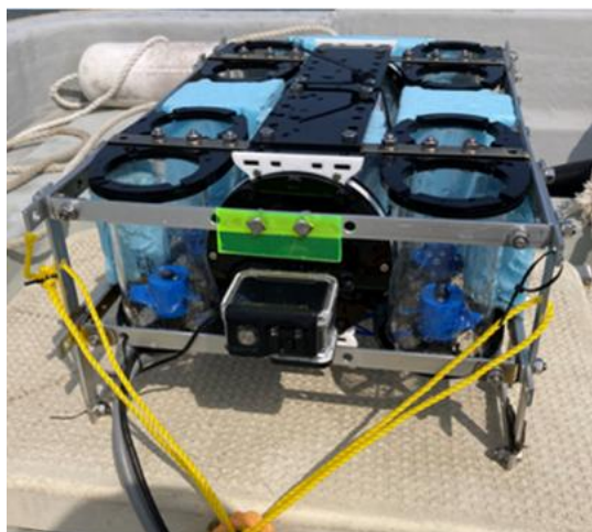
図1-1 計測用水中ドローン機体の外観
